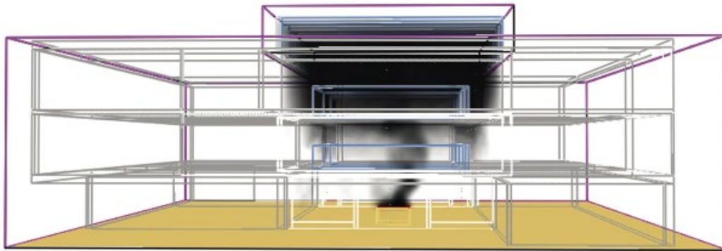
Abbildung 10: Ansicht des CFD-Modells von Osten nach 540 s (9 min) nach dem Einstellen stationärer Verhältnisse
